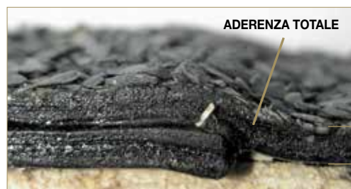
Test di resistenza al distacco delle giunzioni
