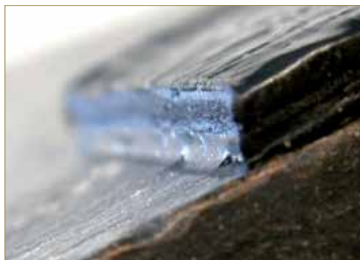
TEST DI RESISTENZA ALLO SCORRIMENTO A CALDO UNI 8202 Parte 16
