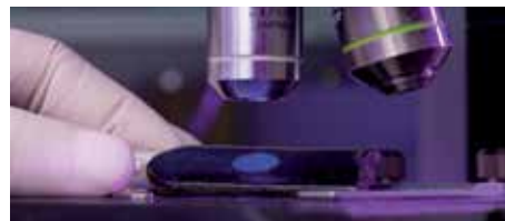
SPESSORE - Microscopio fluorescenza ingrandimento 250X. Normativa UNI EN 1849-1
